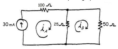
$$i_A = 30 \text{ mA} \quad 25(i_B - i_A) + 50i_B = 0$$
