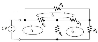
$$(R_2 + R_4)i_1 - R_4i_2 - R_2i_3 = 1$$
